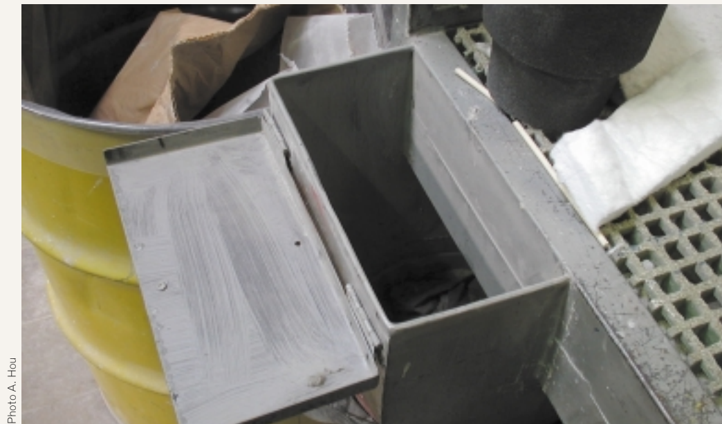
Fig. 13. Poubelle ventilée pour déchets de FCR - Ventilated bin for RCF waste
