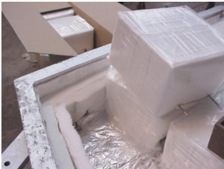
Fig. 10 et 11. Blocs emballés sur cinq faces - Blocks packed on five sides
