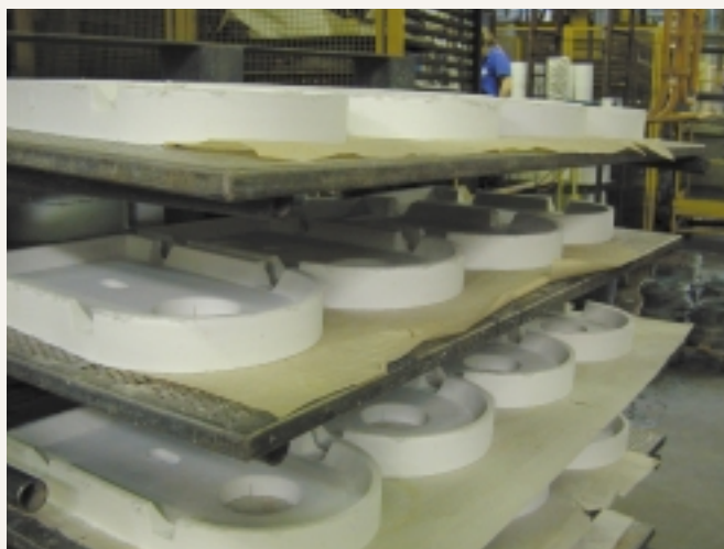
Fig. 18. Papier sulfurisé sur claies de séchage - Greaseproof paper on drying trays
