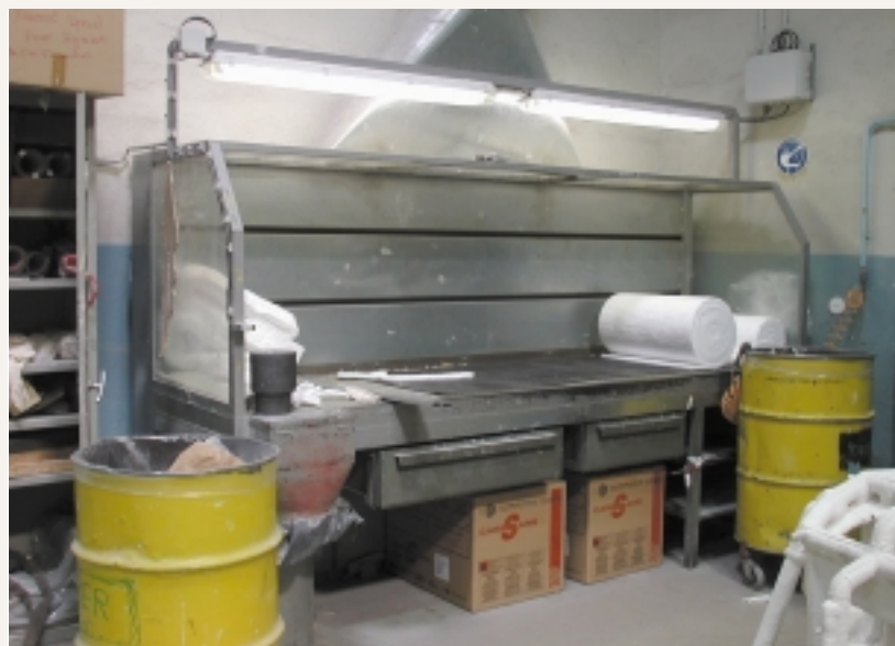
Fig. 12. table aspirante pour découpe de FCR - Ventilated table for cutting RCFs
